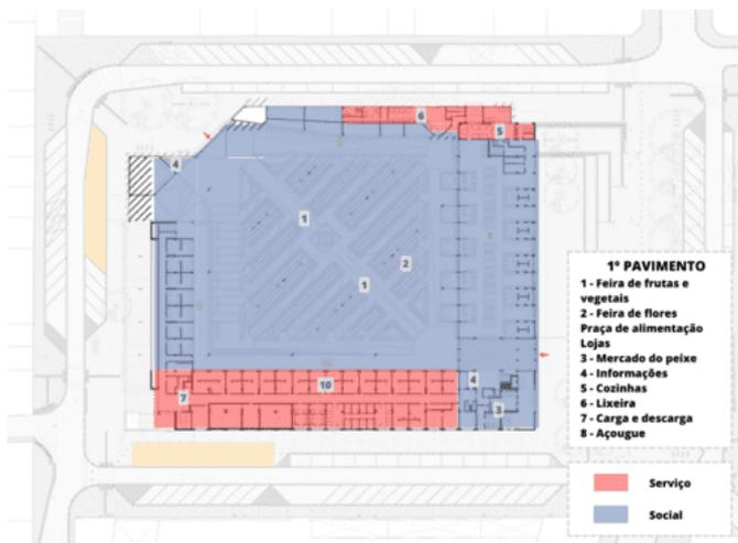
Fig. 10. Planta primeiro pavimento com áreas/setores.
